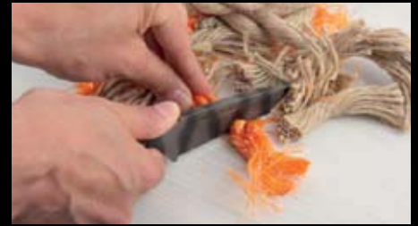
Seile schneiden: Alle Seile konnten geschnitten werden – allerdings unterschiedlich gut.
