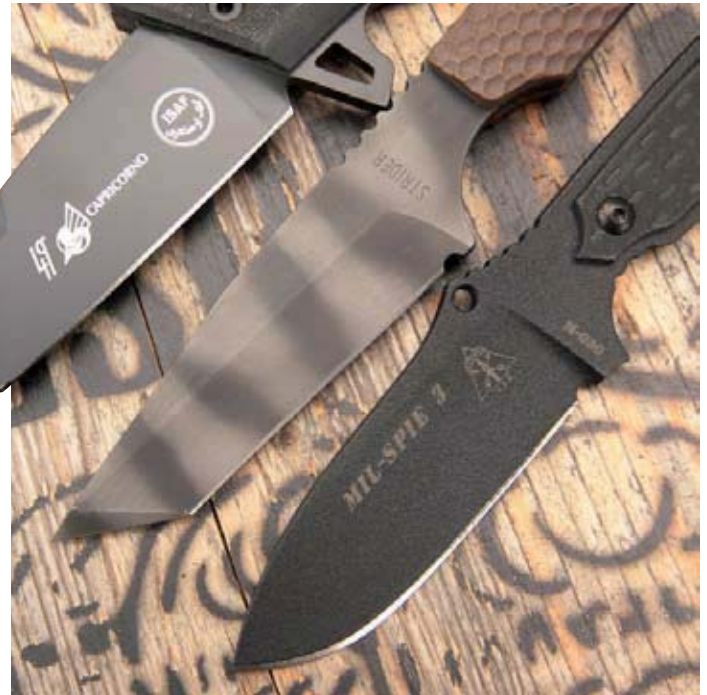
Spitze: Das N.E.R.O. (oben) hat die schneidfreudigste Klinge. Der Klingenträger ist zur Spitze hin mit einer falschen Schneide versehen.
