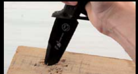
Spitzentest: Die Spitzen wurden in Buchenholz gestoßen und seitlich herausgestemmt.
