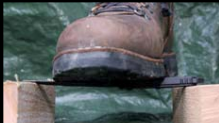
Steighilfe: Die Messer wurden mehrfach mit über 90 Kilogramm belastet.
