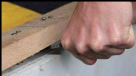
Brechstange: Das Aufhebeln einer zugenagelten Kiste als praxisnaher Belastungstest.
